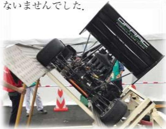
それでも軽微な修正にとどまり、技術車検に合格した後は順調に騒音試験、チルト試験、ブレーキ試験に合格いたしました。車重測定では昨年から20kg以上の軽量化に成功していることを確認しました。2日目以降の審査項目に向けて順調なスタートを切ることができました。
