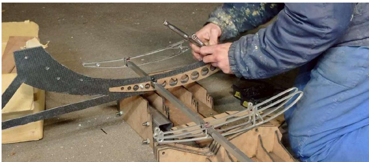
製作面では課題であった、部品の振動を抑える設計・製作を意識し、壊れてもすぐに再製作できるように3Dプリンターを多用しました。
